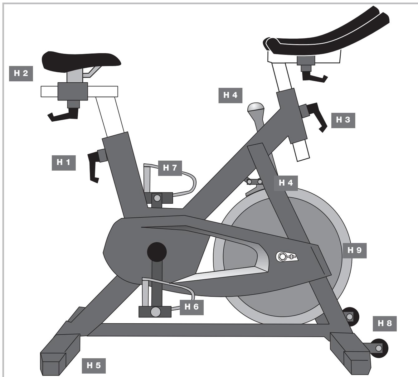
**⚠ Danger!** L'appareil n'a pas de roue libre ! La roue d'inertie est reliée directement aux pédales au moyen d'une courroie trapézoïdale et ne s'arrête pas d'elle-même. Le mouvement peut être arrêté en actionnant le frein d'arrêt d'urgence ou en réduisant de manière contrôlée la fréquence de pédalage.
