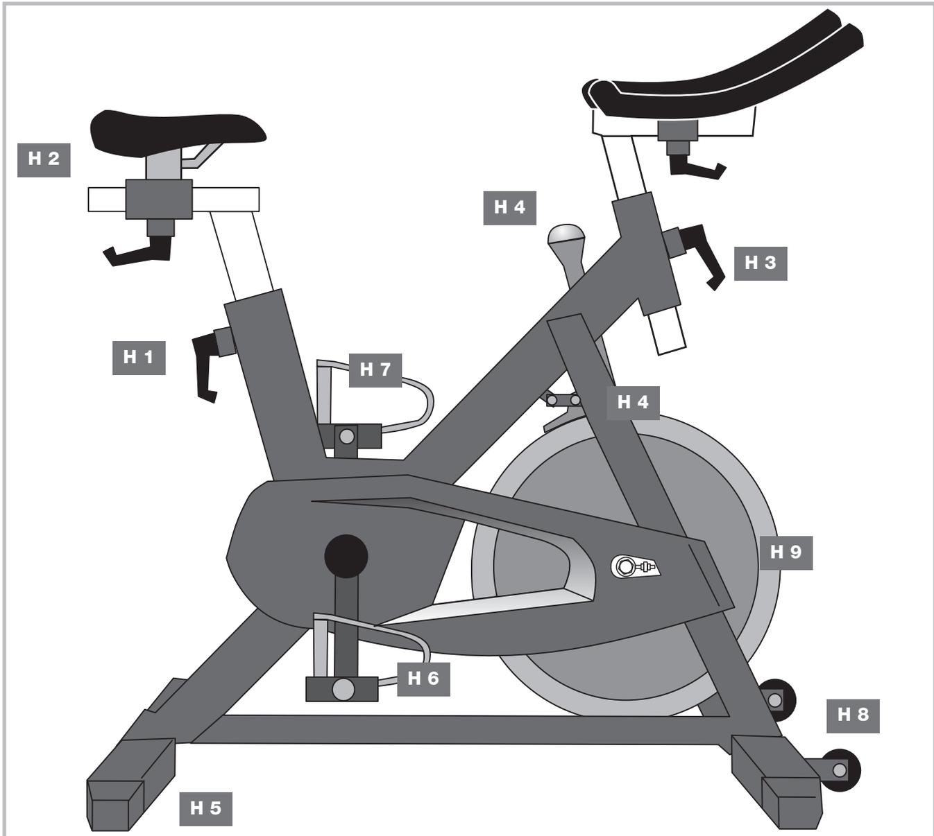
**⚠ GEFAHR!** Das Gerät verfügt nicht über einen Freilauf! Die Schwungscheibe ist über einen Keilriemen direkt mit den Pedalen verbunden und stoppt nicht selbstständig. Die Bewegung kann nur durch Betätigen der Notbremse oder durch kontrolliertes Reduzieren der Trittfrequenz gestoppt werden.
